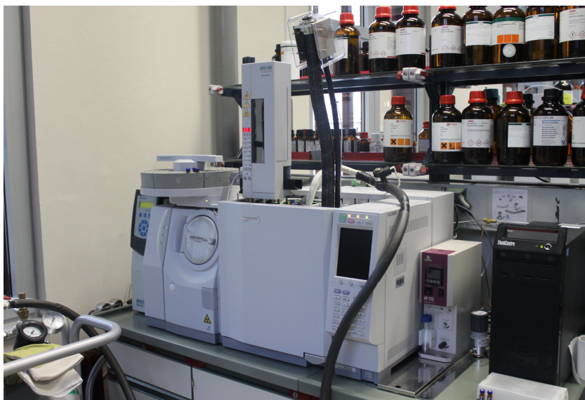
Slika 8: GC-MS analizator na Katedri za farmacevtsko biologijo (Fakulteta za farmacijo).
