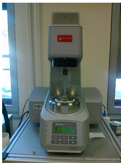
Slika 4 Reometer Physica MCR 301 z merilnim sistemom stožec-plošča (vir: osebni arhiv).
