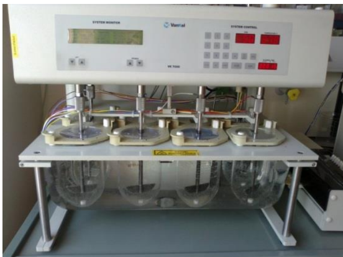
Slika 13: Naprava za preskušanje sproščanja z vesli (naprava II), VanKel 7000.
