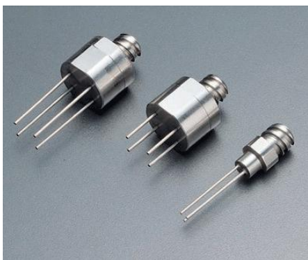
Slika 5: Primera modificiranih naprav z večjim številom šob (20)
