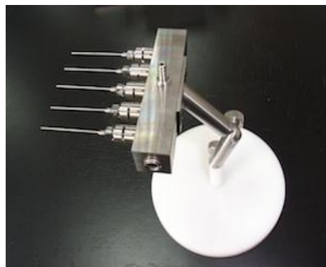
Slika 5: Primera modificiranih naprav z večjim številom šob (20)
