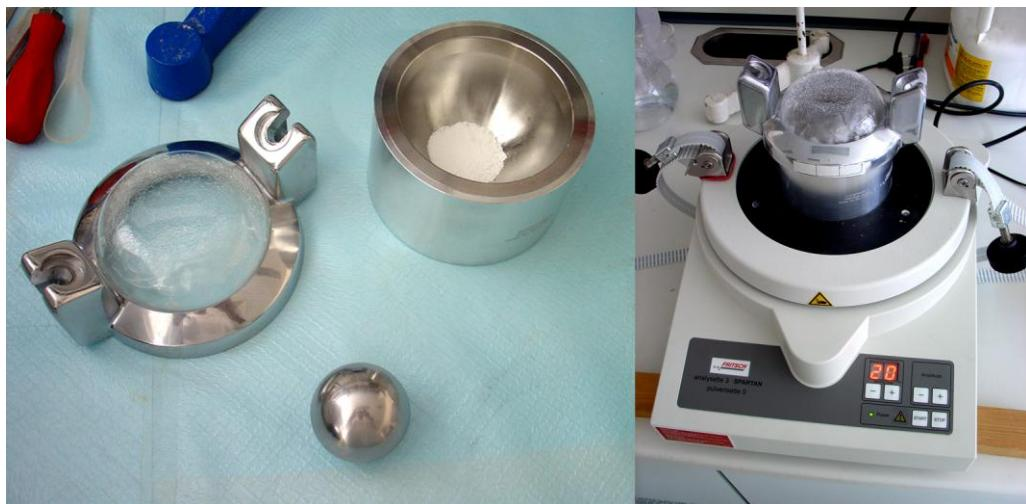
Slika 4: Vibracijski mlin Pulverisette 0, Fritsch
