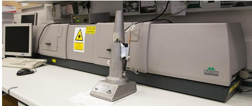
Aparatura omogoča določitev velikosti in porazdelitve velikosti trdnih delcev v območju velikosti med  $0,05\text{--}900\text{ }\mu\text{m}$  na principu laserske difrakcije. Vzorec lahko dispergiramo v zraku (uporaba stisnjenega zraka) ali tekočini (uporaba disperzijske posode z volumenom  $\approx 100\text{ ml}$ ).
