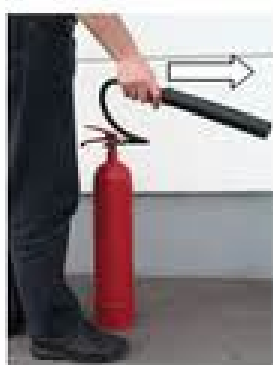
Cev usmerimo proti požaru
