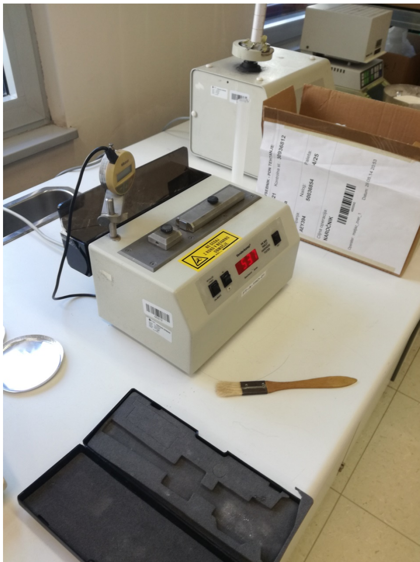
Testni napravi za določanje trdnosti in razpadnosti tablet
