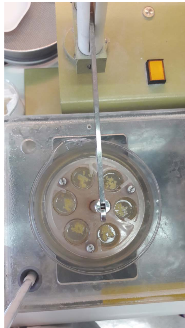
Testni napravi za določanje trdnosti in razpadnosti tablet
