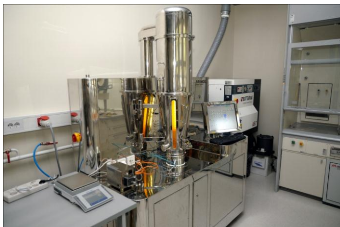
Donirana procesna komora Brinox BX CGD 1 za oblaganje po Wursterju in s "swirl" patentiranim generatorjem zračnega toka.
