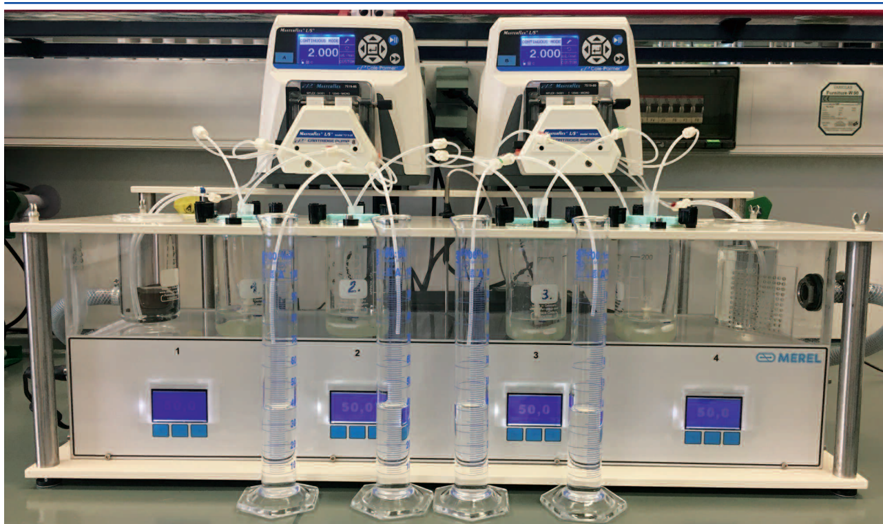
Slika 1: Model za sproščanje – pretočni sistem s kroglicami, razvit na UL FFA.
