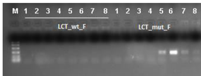
Slika 12: Optimizacija AS- PCR reakcije (M-označevalec dolžin odsekov vsebuje fragmente dolžin 1000, 750, 500, 300, 150 in 50 bp)
