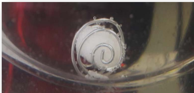
Slika 2: Tableta s hidrofilnim ogrođjem iz polimera HPMC, vgrajena v potapljač. Tableta je slikana peto minuto sproščanja, kjer je zaradi privzema vode in delnega nastanka gelske plasti že nekoliko povečana. Prvotna oblika tablete je prikazana na sliki 10.
