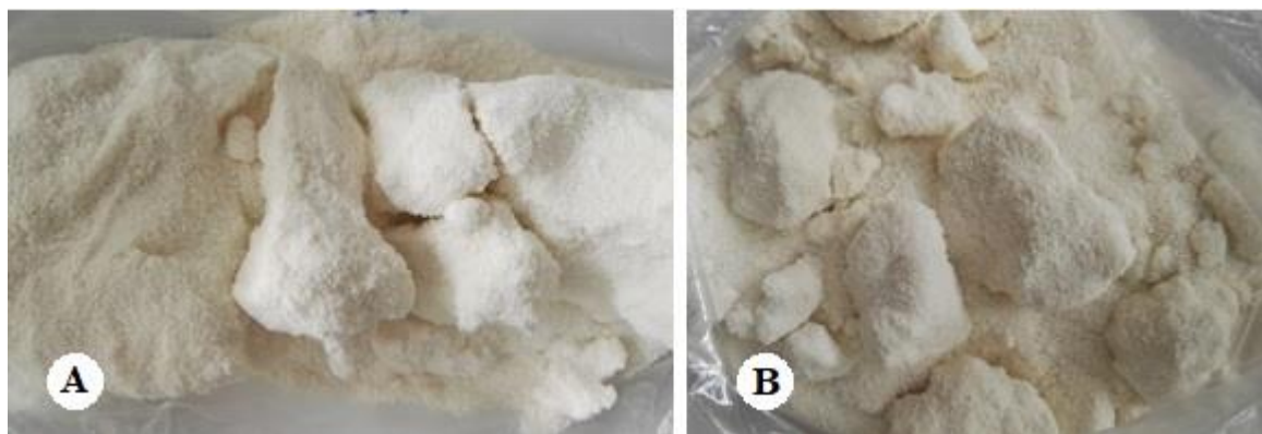
Slika 3: Večji skupki pelet (A) in izgled slednjih po ločevanju skupkov z mehansko silo (B).
