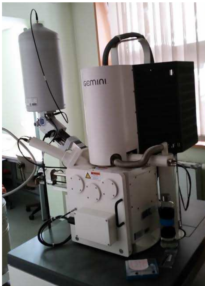
Slika 6: Vrstični elektronski mikroskop Supra 35 VP s Kemijskega inštituta.
