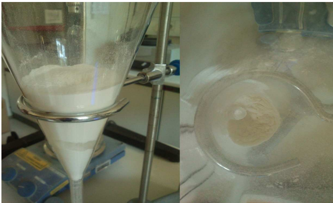
Slika 14: Pojavi pri določanju pretočnega časa: »luščenje« po plasteh (levo) in odtekanje le ob strani (desno).
