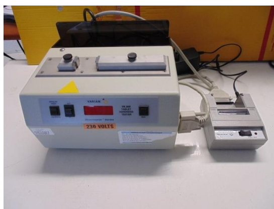
Slika 26: Naprava za določanje trdnosti tablet, Tablet hardness tester VK 200, Vanderkamp
