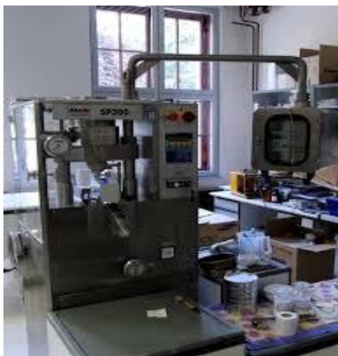
Slika 25: Hidravlična tabletirka na udarec, Killian SP 300, IMA [57]
