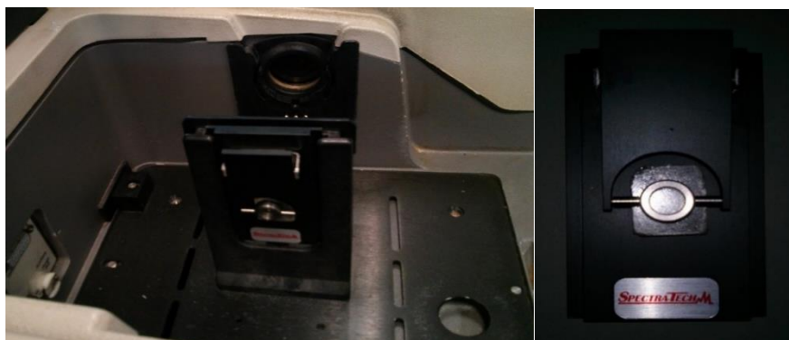
Slika 5: Nastavek z vpenjačem za NaCl ploščico za transmisijsko tehniko IR spektroskopije (levo) in vpenjač z NaCl ploščico (desno)
