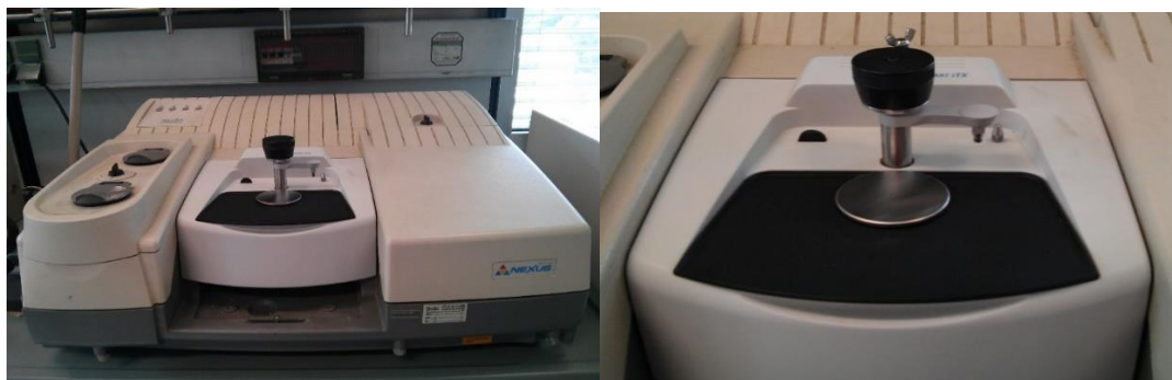
Slika 2: FTIR spektrometer Nicolet Nexus z ATR nastavkom (levo) in ATR nastavek (desno)
