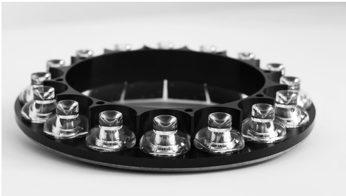
Slika 9: Vzbujevalni sestavni del z LED, na katerih so nameščene sekundarne optike
