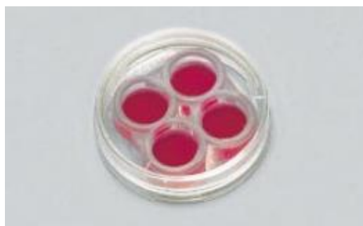
Slika 6: Z vložkom flexiPERM® disc opremljena petrijevka Lumox® s štirimi ločenimi celičnimi kulturami.
