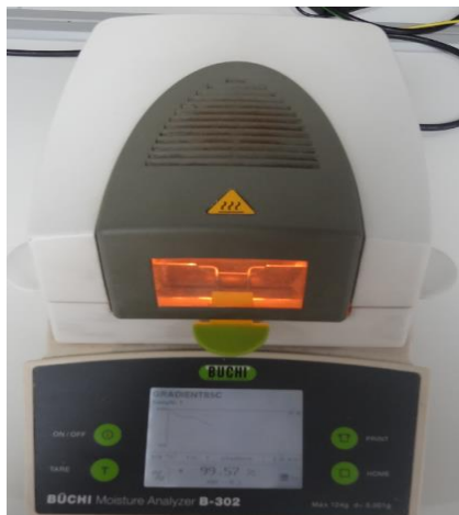
Slika 14: Tehnica s sušilno enoto; B-302, Büchi
