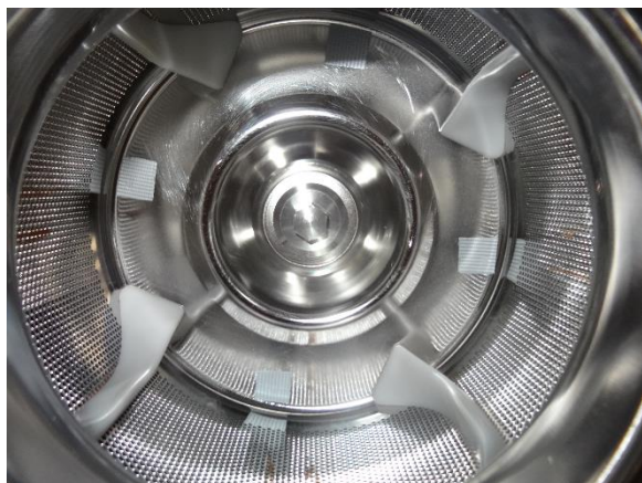
Slika 33: Perforiran boben s štirimi mešalnimi stopnicami
