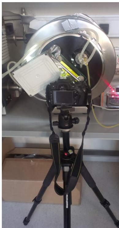
Slika 26: Snemanje plazenja tablet v bobnu med oblaganjem
