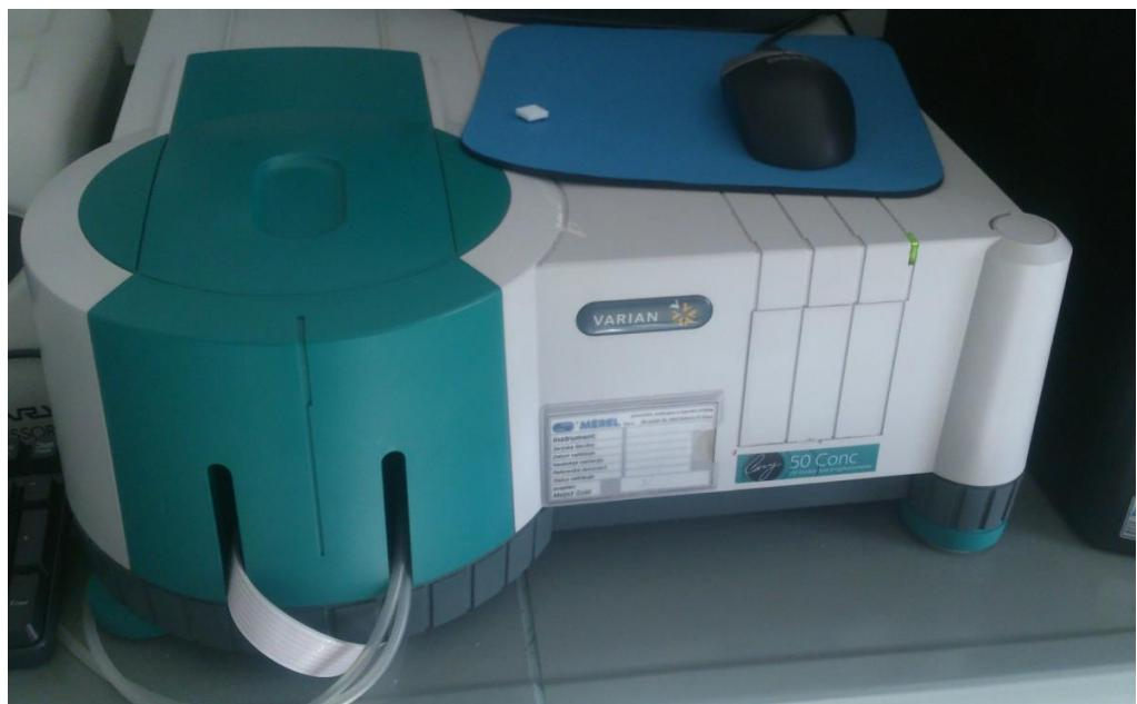
**Slika 8:** UV/VIS spektrofotometer Cary 50 Conc proizvajalca Varian, s katerim smo izmerili absorbance spojinam pri deoksiriboznem testu
