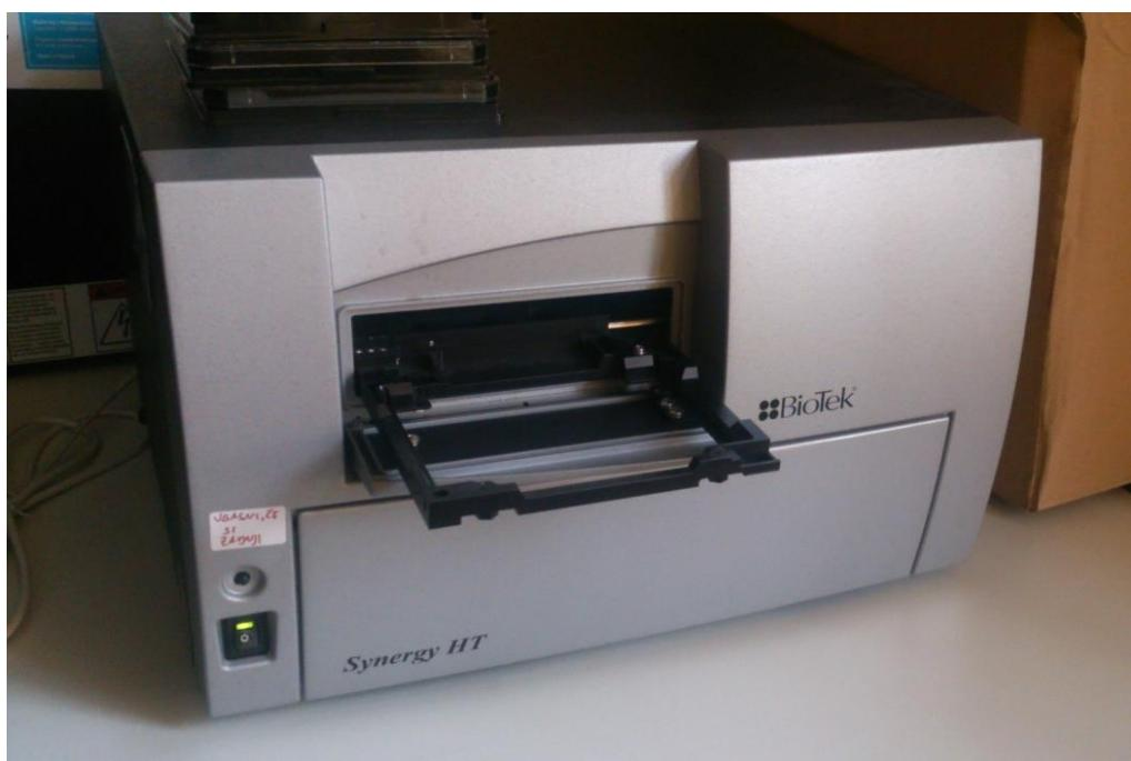
**Slika 7:** Čitalec mikrotitrskih plošč Synergy<sup>TM</sup> HT proizvajalca Biotek s katerim smo izmerili absorbance spojinam pri ferozinskem testu
