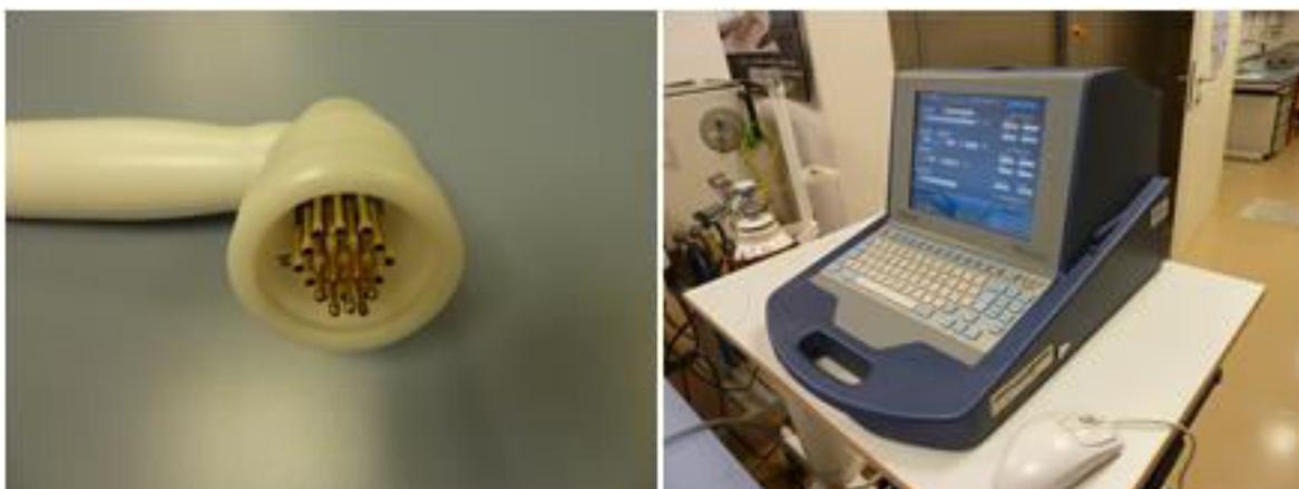
**Slika 14: Uporabljene elektrode in elektroperator.**
