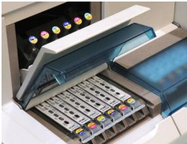
Slika 13: Reagenčni trakovi in zbirnik trdne faze v aparatu mini Vidas pred začetkom izvajanja testa, povzeto po (65).
