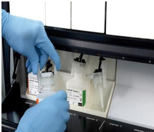
Slika 17: Priprava reagentov na aparatu Liaison, povzeto po (72).
