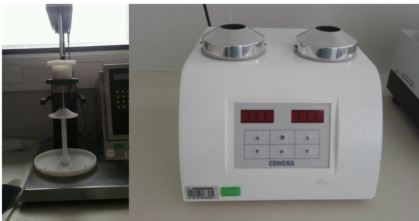
Slika 14: Merilec pretočnosti in nasipnega kota zmesi: Pharma test (levo) in naprava za merjenje nasipnega in zbitnega volumna: Erweka (desno).
