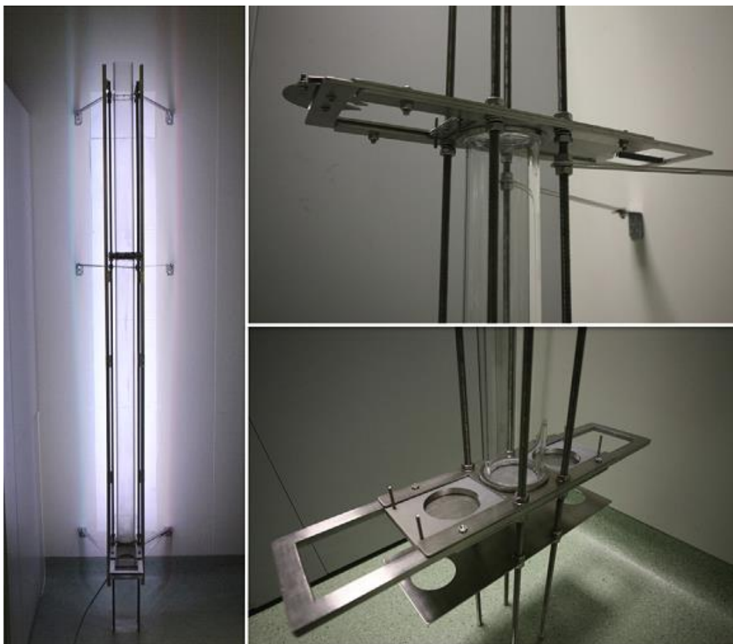
Slika 12: Vertikalna cevna povezava za testiranje segregacije (levo), detajli zasuna (desno zgoraj) in loputa za vzorčenje (desno spodaj) [101].
