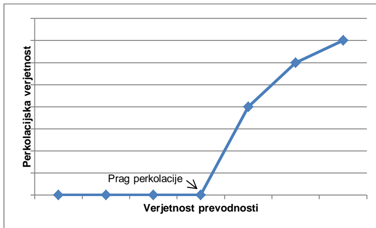
Slika 25: Grafični prikaz odvisnosti perkolacijske verjetnosti od verjetnosti, da bo zmes električno prevodna.
