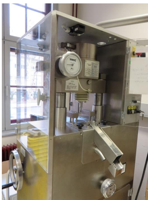
Slika 6: Tabletirka, ki smo jo uporabljali za izdelavo samomikroemulgirajočih tablet.
