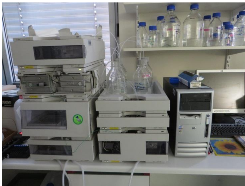
Slika 9: HPLC naprava, ki smo jo uporabljali za ugotavljanje koncentracij ZU.
