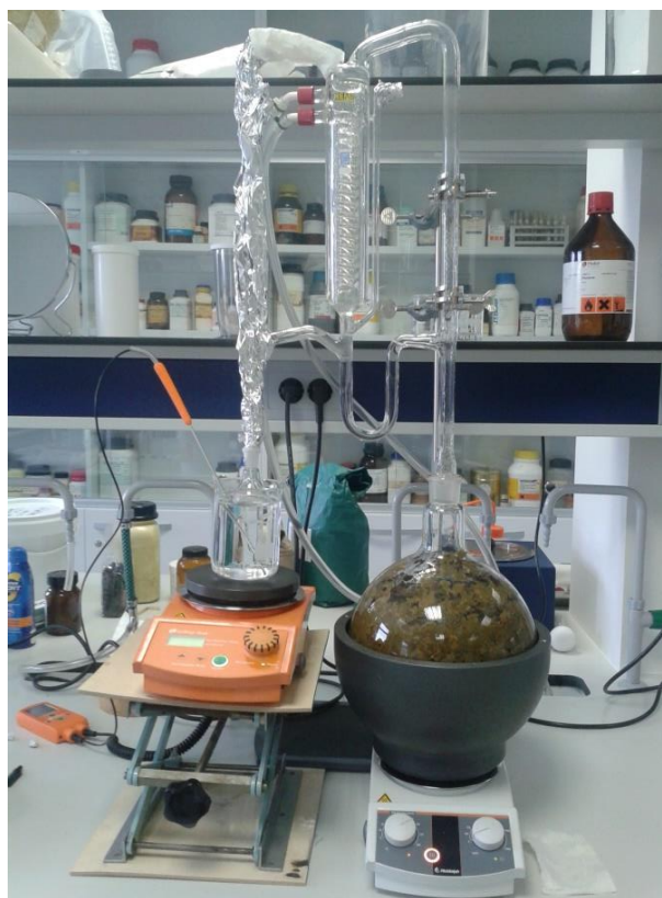
Slika 8: Likens-Nickersonova aparatura za destilacijo. Foto: Andreja Štalcar
