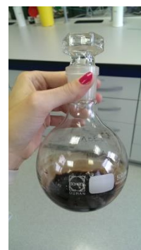
Slika 25: Temno rjav produkt po rotavapiranju
