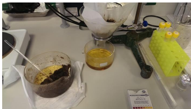
Slika 23: Filtracija preko filtrirnega papirja
