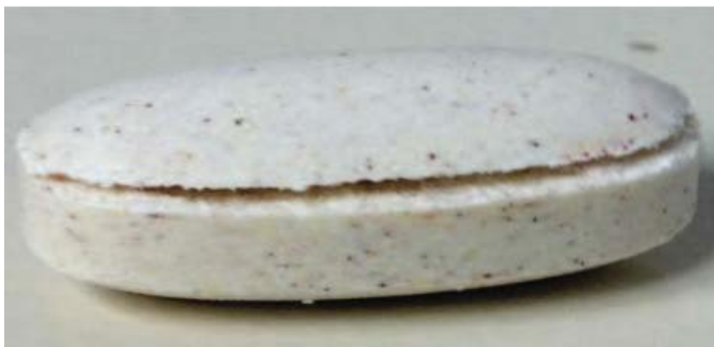
Slika 8: Prikaz poškodbe tablet: nastanek kopic ali laminacija tablet (31).
