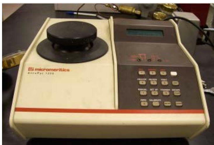
Slika 18: Helijev piknometrom, AccuPyc 1330 Pycnometer, Micromeritics, ZDA.
