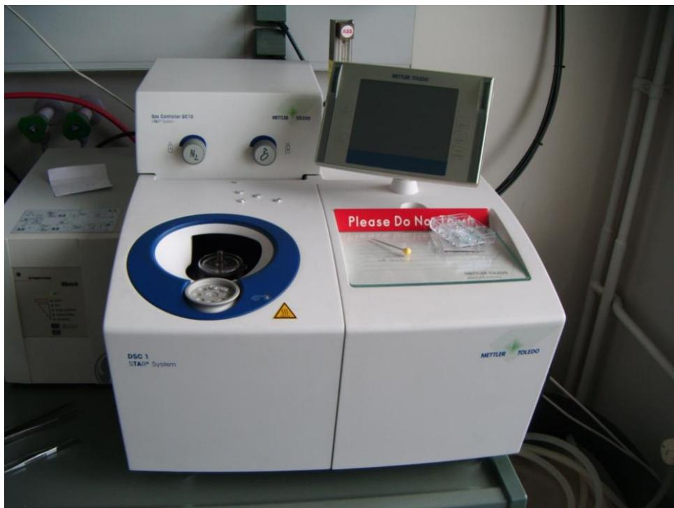
Slika 16: Diferenčni dinamični kalorimeter (DSC 1 Star System, Mettler Toledo, Švica)
