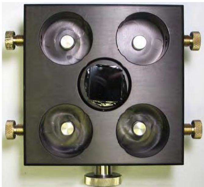
Slika 19: Nosilec vzorcev, Nanoindenter G200, Agilent Technologies, ZDA (19)
