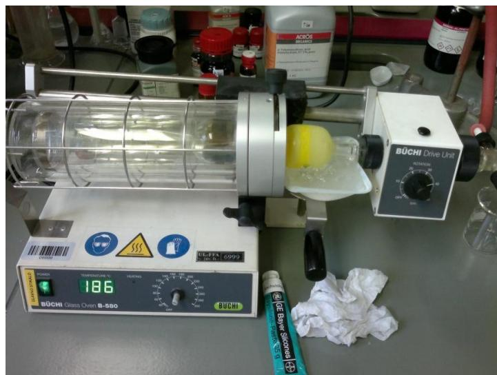
Slika 18: Aparatura za kratkopotno vakuumsko destilacijo (vir: S. Majcen)
