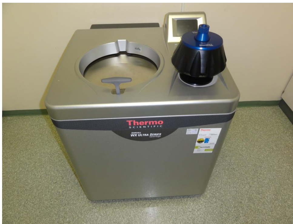
Slika 6: Ultracentrifuga serije WX ULTRA 100 in rotor T- 1250 .
