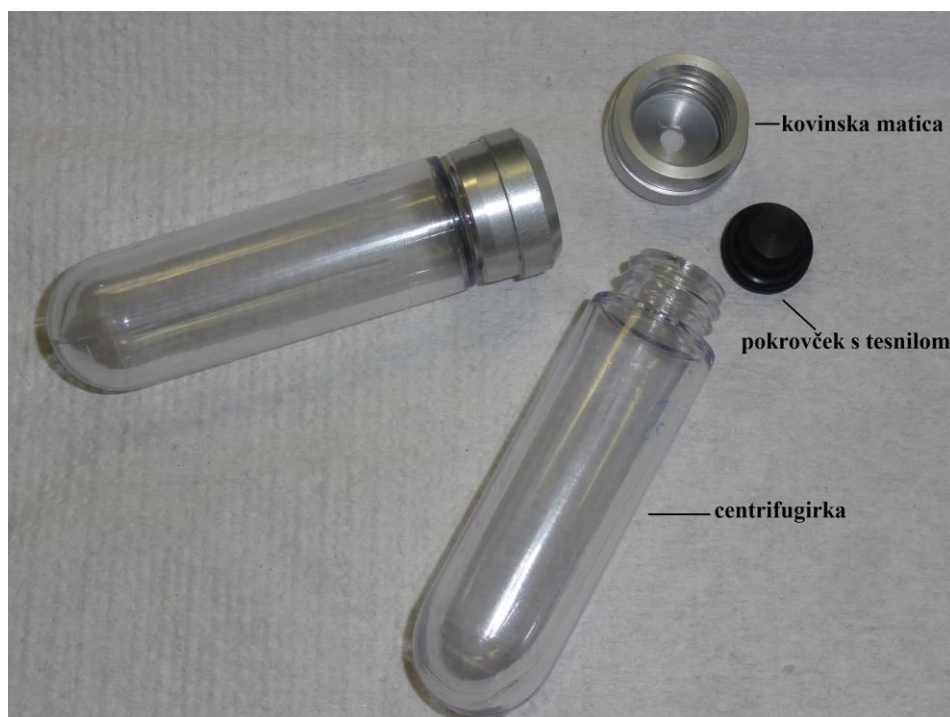
Slika 15: Centrifugirki za uporabo v ultracentrifugi.
