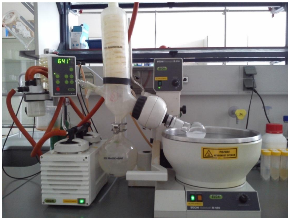
Slika 9: Rotavapor za pripravo TD z metodo odparevanja topila pri znižanem tlaku.
