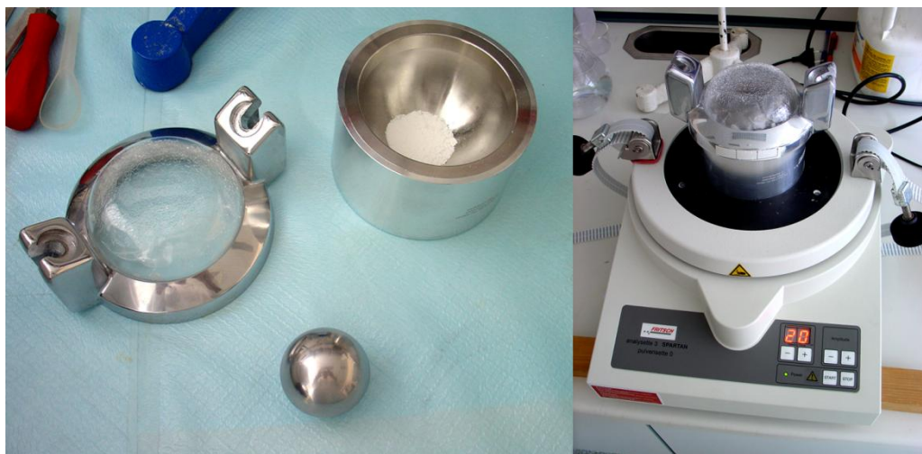
Slika 8: Vibracijski mlin Pulverisette 0 s posodo in kroglo za mletje.
