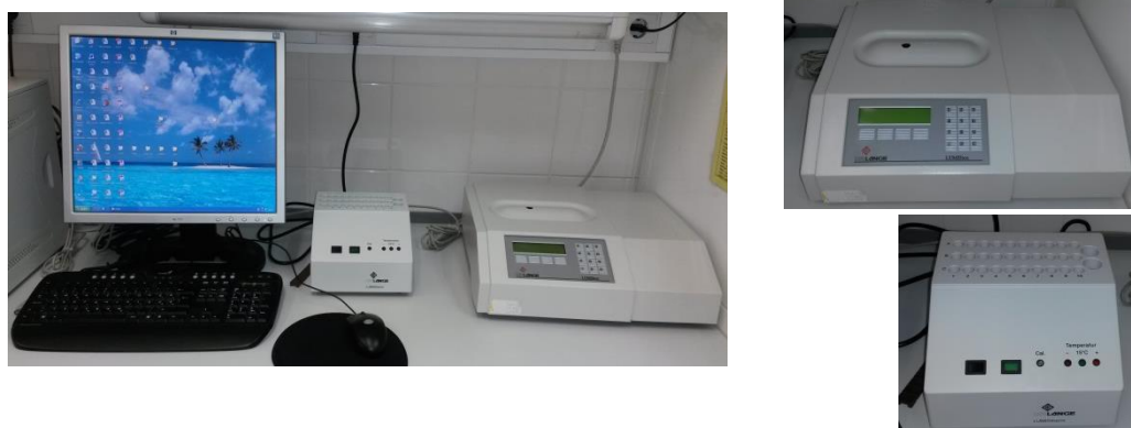
Slika 15: Aparature za delo z luminiscenčnimi bakterijami Vibrio fischeri ; desno zgoraj vidimo merilni instrument (LUMIStox 300), pod njim pa termoblok (LUMIStherm)
