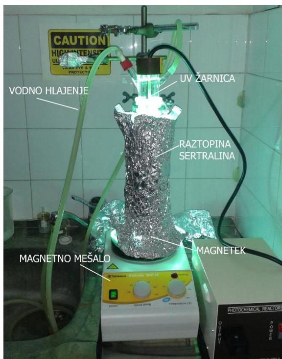
**Slika 13:** Aparatura za UV-obsevanje.
