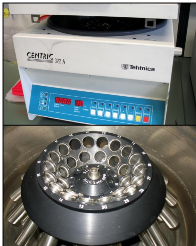
Slika 9: Zunanost in notranjost centrifuge za izvedbo ultrafiltracije
