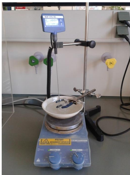
Slika 3: Priprava za določanje temperature geliranja formulacij z magnetnim mešalom
