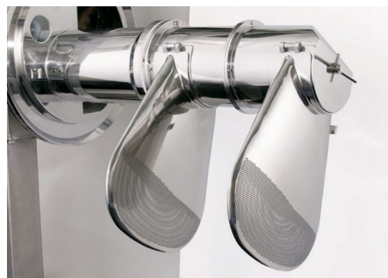
Slika 6: Lemeži, ki v primeru oblaganja tablet odvajajo zrak. Ležijo v nasutju tablet (17).
