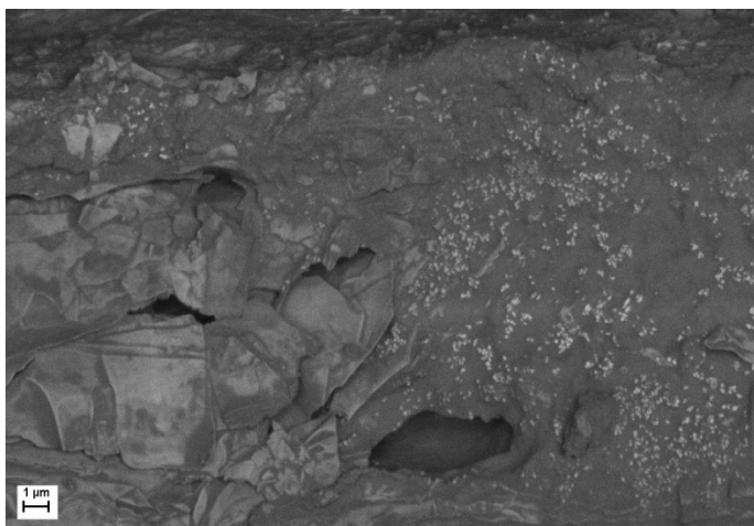
Slika 50: Filmska obloga formulacije A pod 10.000-kratno povečavo. Levo smukec z lamelarno strukturo, desno delci TiO 2 , ujeti v polimernem ogrodju.
