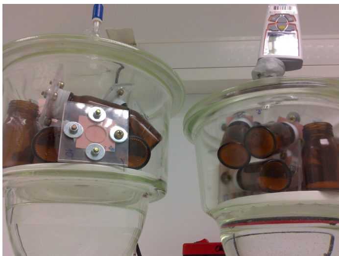
Slika 17: Izvajanje vrednotenja permeabilnosti 2 na pogojih 22 °C/65 % RV in 22 °C/100 % RV v eksikatorjih
