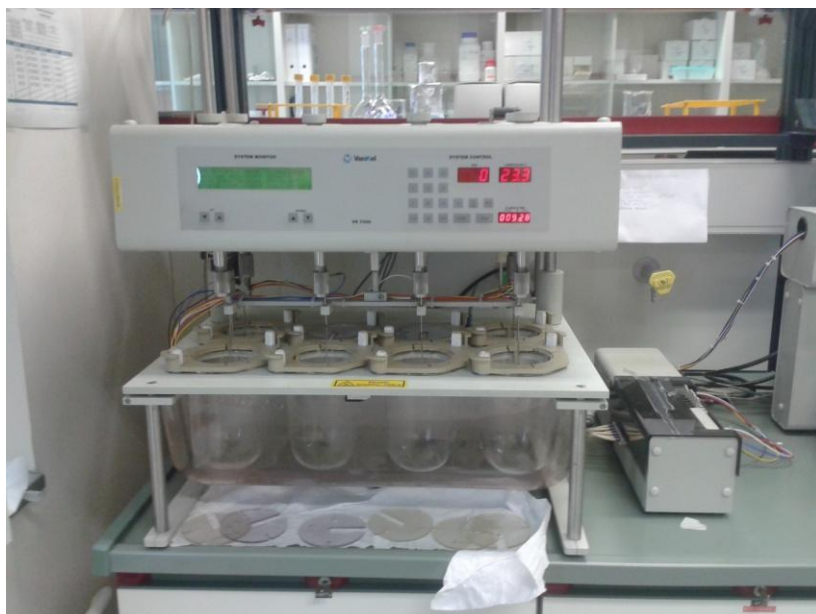
Slika 9: Naprava za izvajanje preskusa sproščanja VK 7000 – Vankel.
