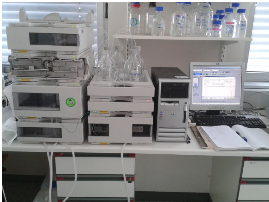
Slika10: HPLC, naprava za določanje koncentracije učinkovin.
