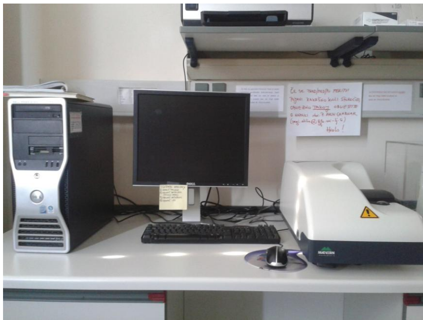
Slika 8: Naprava za merjenje velikosti kapljic notranje faze Zeta sizer Nano.
