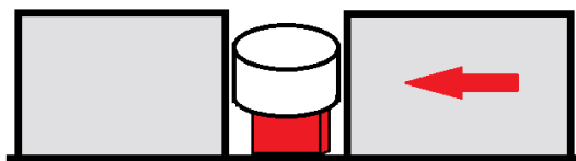
Slika 7: Prikaz uporabe distančnika (rdeče barve) pri merjenju trdnosti tablet izdelanih iz polnila DCPD.
