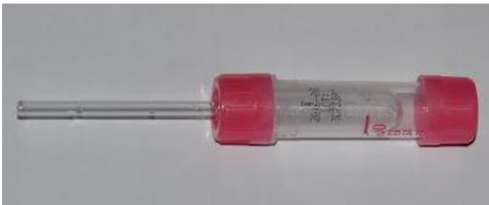
Slika 7: Epruveta za kapilarni odvzem z volumnom 200\ \mu\text{L} in z dodanim K_3EDTA .
