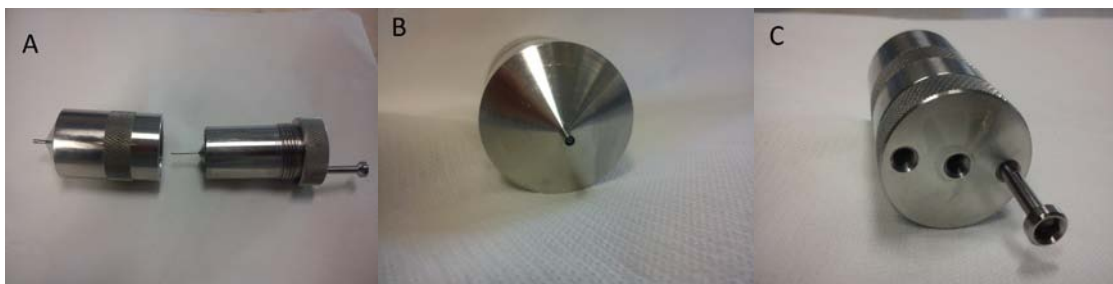
Slika 2: Prikaz koaksialne šobe, ki smo jo uporabljali za izdelavo dvoslojnih nanovlaken.
