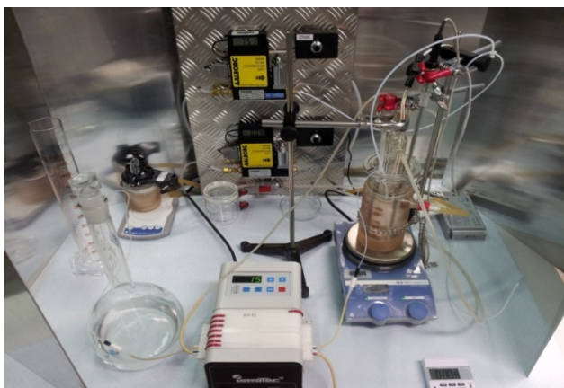
Slika 5: Sestavljen sistem za izvedbo fotokatalitske oksidacije v pretočnem mešalnem reaktorju.
