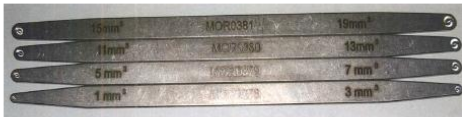
Slika 14: Merilne žličke z različnimi volumni (1-19 mm 3 )
