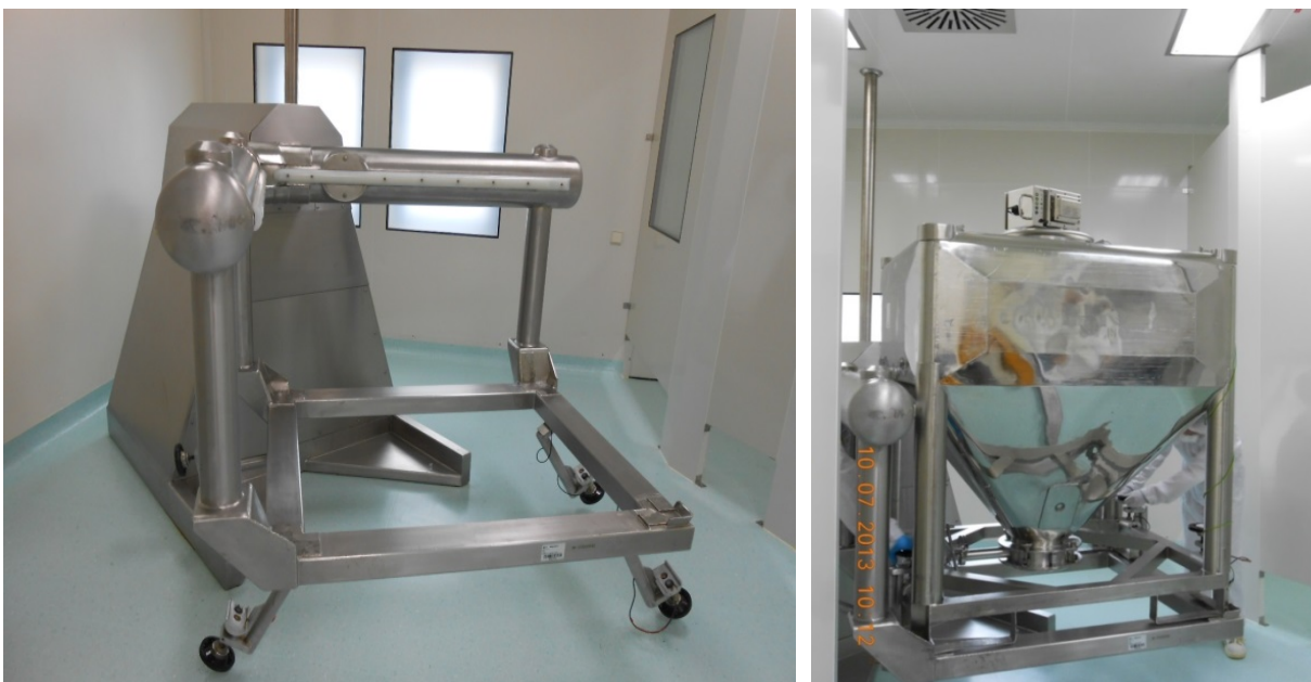
Slika 20: Vpenjalni mešalnik (slika levo); kontejner z nameščenim NIR inštrumentom pritrjen na nosilno ploščo vpenjalnega mešalnika (slika desno)
