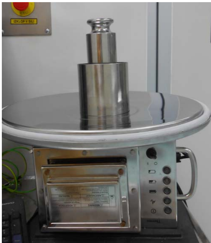
Slika 23: Prikaz snemanja standardnih vzorcev za izgradnjo kalibracijske krivulje za snemanje spektrov na mešalniku: vzorec v valju obtežen z 2 kg utežjo
