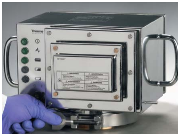
Slika 18: Predelan pokrov mešalnika v sredini je vgrajeno safirno steklo, skozi katerega inštrument snema zmesi (slika levo); uporabljeni NIR inštrument (slika desno)
