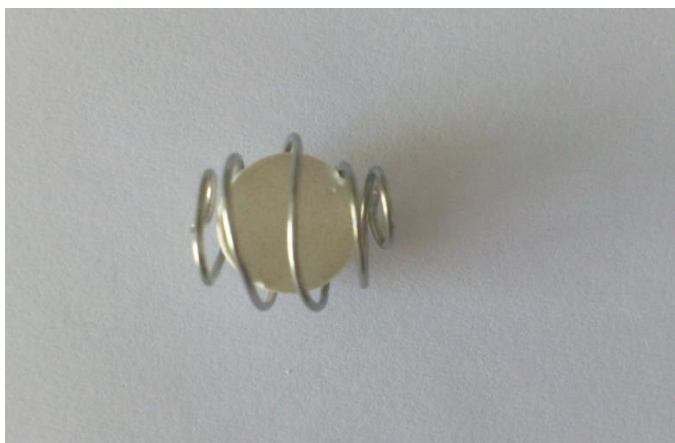
Slika 11: Vzorec tablete ovit v inertno žičko s katero smo preprečili lepljenje tablete na dno posode.
