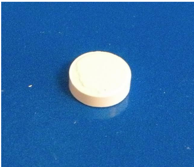
Slika 17: Tableta iz liofilizata 4 % (manitol + dekstran + PEG)
