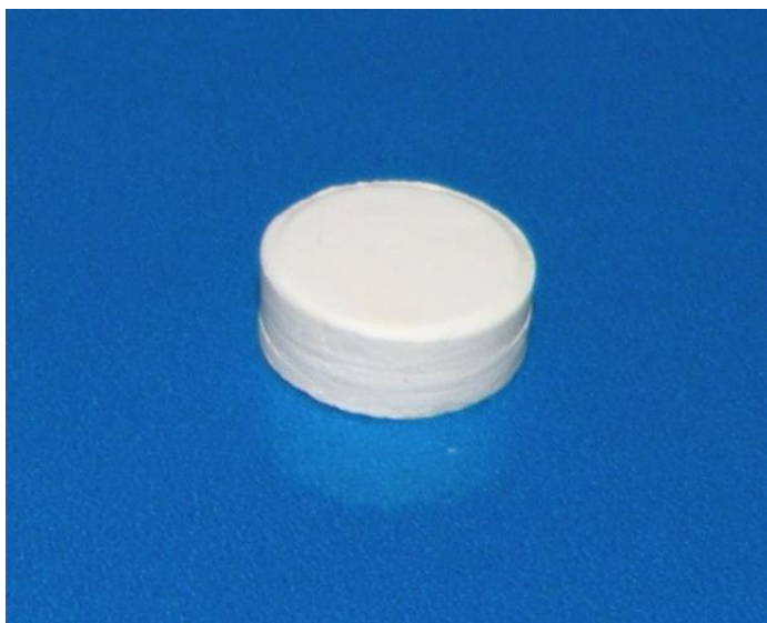
Slika 19: Tableta iz liofilizata 4 % (manitol + dekstran + PVP)
