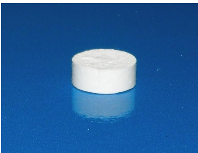
Slika 18: Tableta iz liofilizata 4 % (manitol + dekstran + poloksamer)
