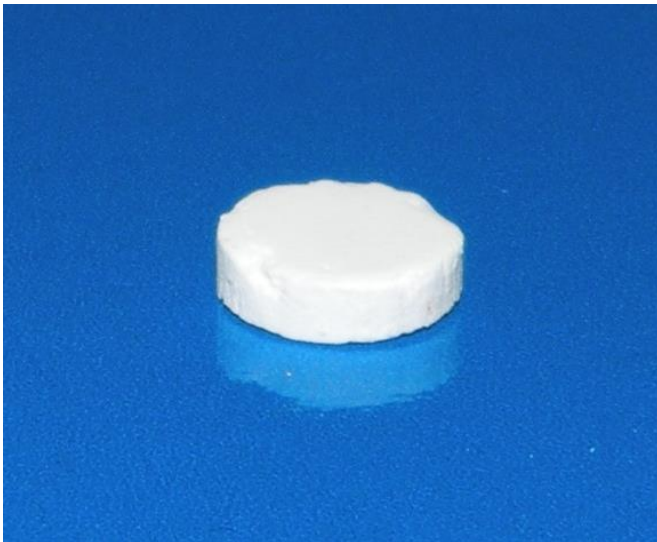
Slika 15: Tableta iz liofilizata 4 % (manitol + saharoza)
