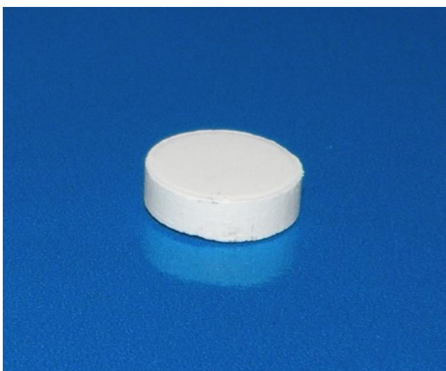
Slika 14: Tableta iz liofilizata 2 % dekstran
