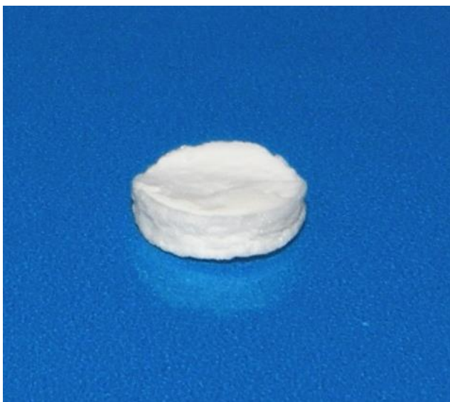
Slika 12: Tableta iz liofilizata 4 % trehaloza
