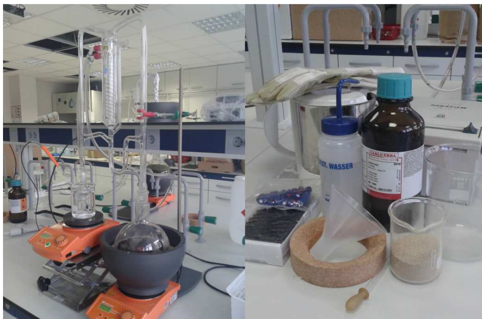
Slika 7: Izvedba kodestilacije in uporabljen pribor (Foto: S. Medved).
