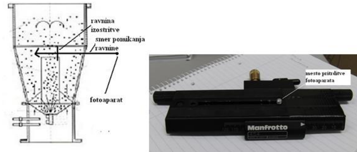
Slika 12: Shematski prikaz pomikanja ravnine izostritve (levo) in pomična mizica s pomočjo katere smo premikali fotoaparatus (desno)
