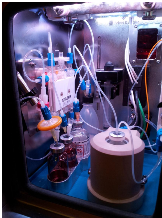
Slika 27: Notranjost avtomatskega sinteznega modula, kjer poteka radiooznačevanje. V osrednjem delu je reakcijska viala s peptidom, v katero se steka ^{68}\text{Ga} eluat. Ob levi strani stene je pritrjen kasetni sistem.
