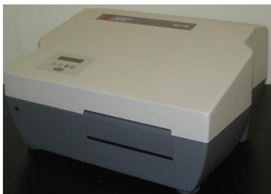
Slika 9 : Čitalec mikrotitrskih plošč AD 340 (Beckman Coulter, ZDA)
