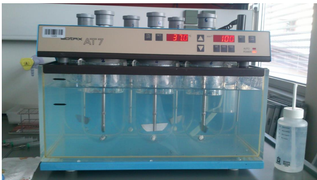
Slika 6: USP 2 aparatura za teste sproščanja.
